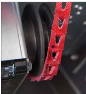
Изображение 7.4.4.1: Направление движения ремня отмечено на нем стрелкой.
