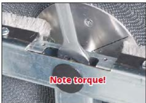
Изображение 4 После установки ротора под нужным углом, затяните шестигранные винты до полной фиксации.
