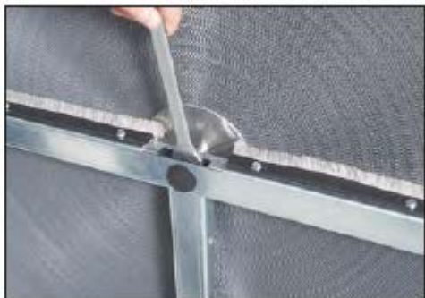
Изображение 1 Ослабьте шестигранный винт.
