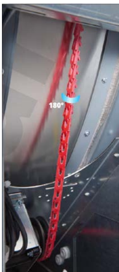
Изображение 7.4.4.2: Убедитесь, что ремень вращается вокруг шкива двигателя и ротора, как показано на изображении. После установки ремень вращается на 180 градусов при вращении ротора.
