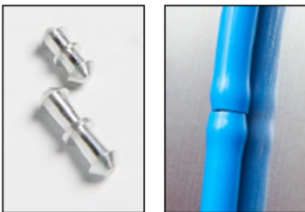
Kuva 7.4.4.2: Toimitetut liittimet hihnan vaihtoa varten
