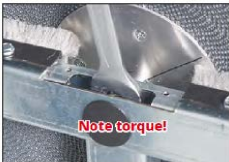
Kuva 4 Kun roottori on asetettu sopivaan kulmaan, kiristä kuusiokantaruuvi oikeaan momenttiin.
