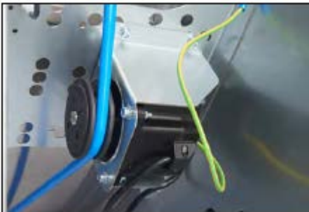
Kuva 7.4.4.1: Joustava pyöreä hihna roottorikäyttöön
